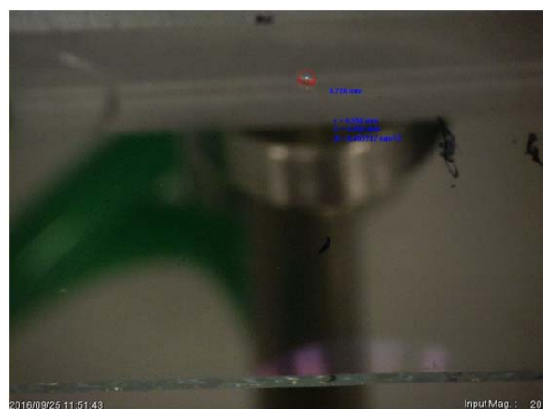
شکل-۴: تصویر یک نمونه لایه Ta 2 O 5 که توسط لیزر تخریب شده است. ناحیه که با دایره قرمز مشخص شده تخریب شده است.
