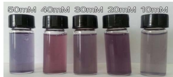
شکل (۳): شکل نانوساختارهای ZnO-Au ساخته شده با غلظت‌های مختلف محلول \text{HAuCl}_4
