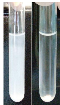
شکل ۱: تشکیل رسوب در انتهای لوله در اثر فرایند سانتریفیوژ
