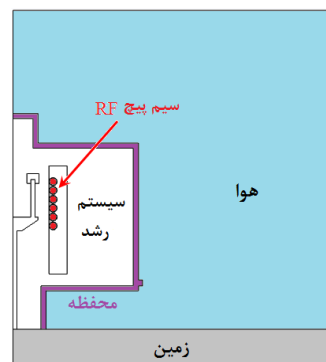
شکل ۱: طرح حوزه محاسبه، شامل سیستم رشد بلور چکرالسکی و محیط اطراف آن در آزمایشگاه.
